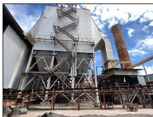
รูปที่ 2 เครื่องดักฝุ่นแบบมัลติไซโคลน (Multi cyclone)
