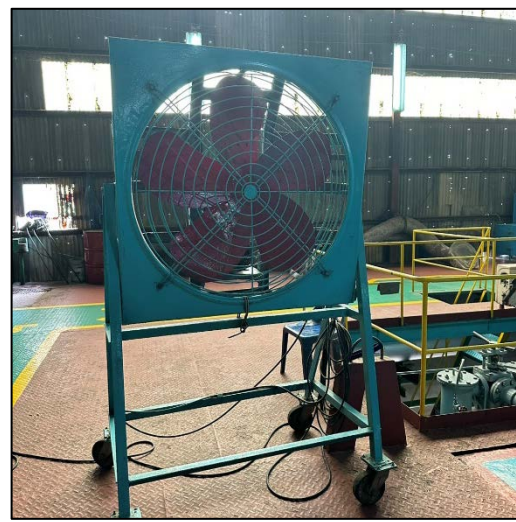
รูปที่ 68 ติดตั้งพัดลมถ่ายเทอากาศ ระบายความร้อนในพื้นที่ปฏิบัติงาน
