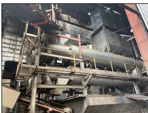
รูปที่ 3 เครื่องดักจับอนุภาคด้วยไฟฟ้าสถิต (Electrostatic Precipitator หรือ ESP)
