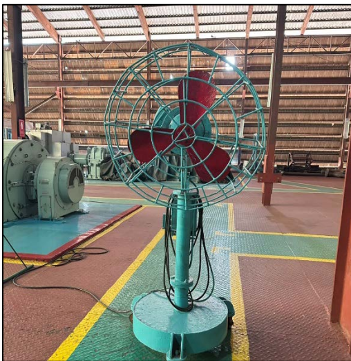
รูปที่ 68 ติดตั้งพัดลมถ่ายเทอากาศ ระบายความร้อนในพื้นที่ปฏิบัติงาน
